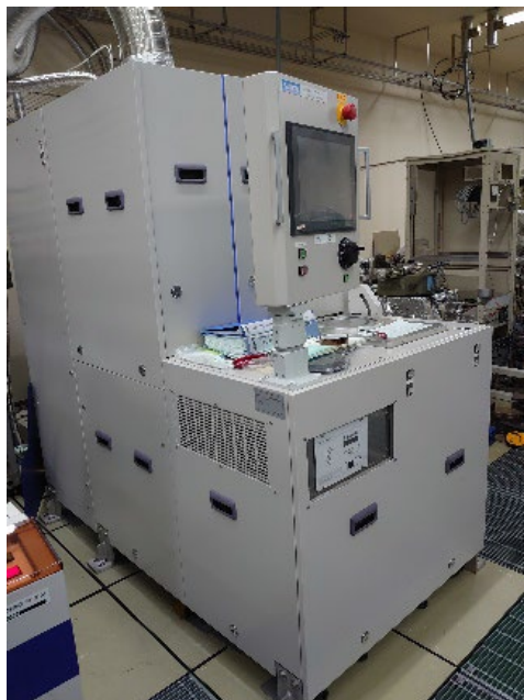
修理された ICP-RIE 装置の外観
