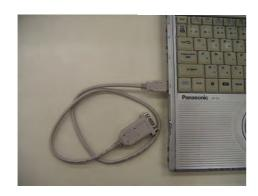
写真 5 USB-シリアル変換ケーブルと PC の接続
