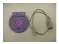
写真4 USB-シリアル変換ケーブルと ドライバCD
