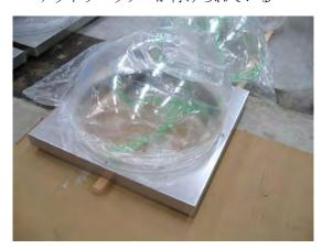
図 15 製作したアクリルドーム天窓 アクリルドームの下には、コンテナと接合す るためステンレス枠を付けた
