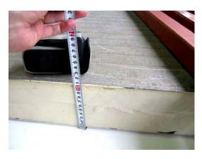
図4 冷凍コンテナの断熱壁 上面が外側
