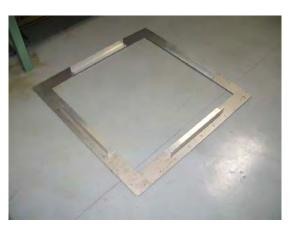
図 14 ナットリベッター用の穴位置ガイド板 施工中の開口部に取り付けて、ナットリベッター の下穴をあける際に使用してもらった
