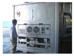
図3 冷凍コンテナに内蔵された冷凍機ユニット
