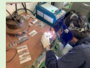
TIG溶接法による高品質・高精度な溶接
