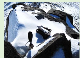
山岳地帯等の過酷な環境での 遠隔通年地震観測システム構築
