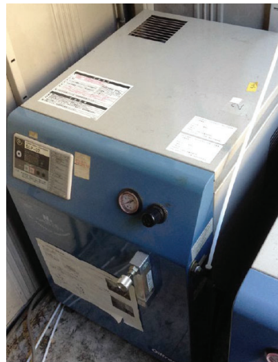
ESI-イオントラップ型質量分析計(NUESSID17)の付帯設備、窒素ガス発生器 パネルを取り外すことが困難なため、窒素ガス発生器の全体像
