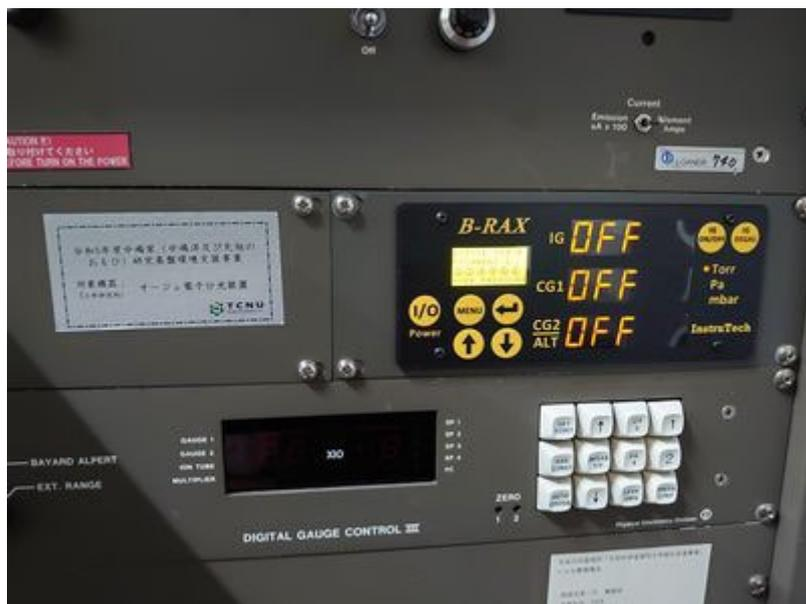
改修前に不調となっていたデジタルゲージコントローラーは交換機種が無く、装置本体を動作させることが不可能となっていた。そこで、写真上に表示されている代替真空計に交換したことで装置をこれまで同様に使用することができるようになった。
