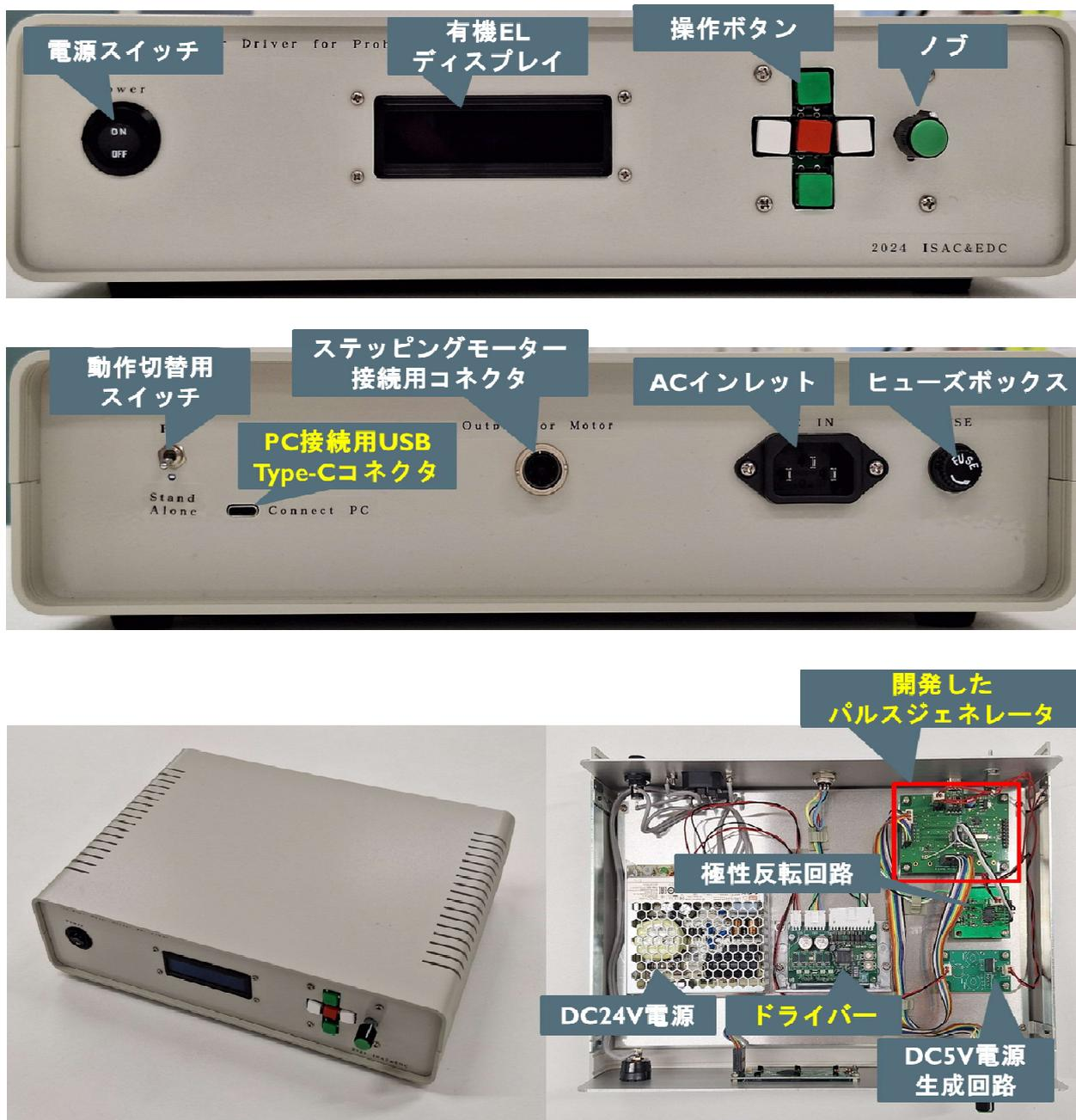
図7：図3のプリント基板を用いて構成したステッピングモーターコントローラ
