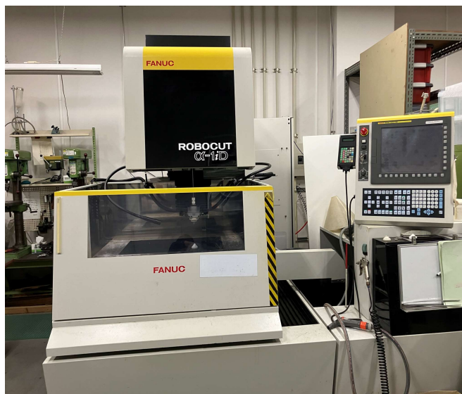
図8. ワイヤー放電加工機 Fanuc α-lid
