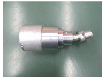
図5. チャックから脱落实破損
