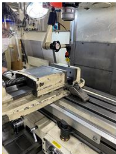
図-6 バイスの平行出し
