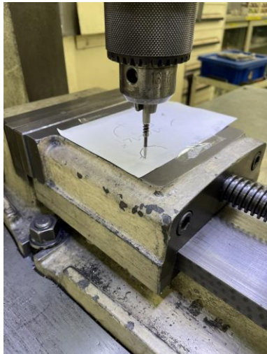
図-10 汎用フライスで R 加工の練習
