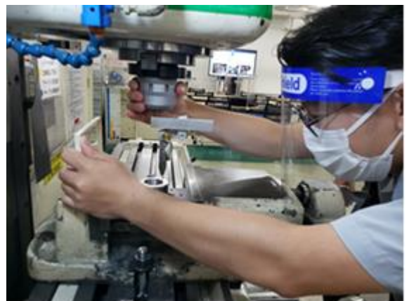
図-5 主軸の同軸円出し
