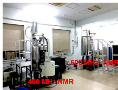
図1. 名古屋大学の核磁気共鳴装置 JNM-ECA 600とJNM-ECZ400 (JEOL)
