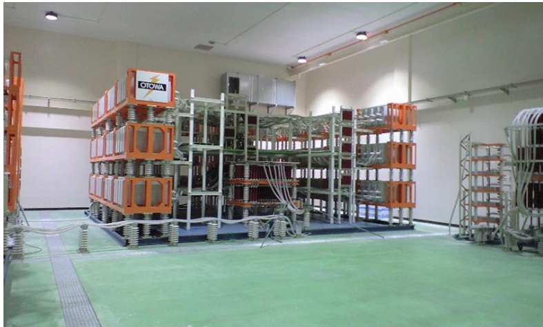
図3. コンポーネントA/D発生器
