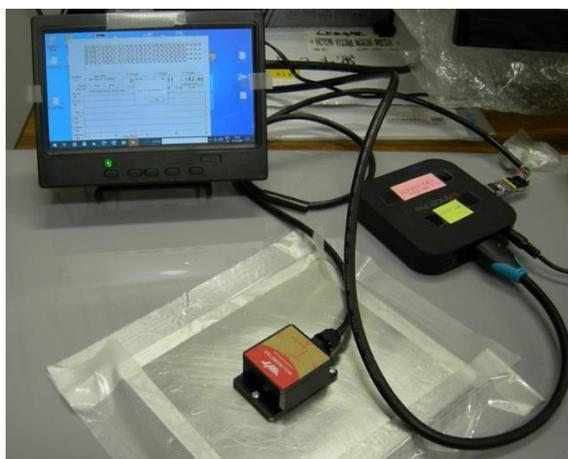
図5. 9軸加速度センサー (HWT905-TTL MPU-9250) とデータ処理システム
