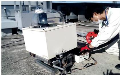
図 18. 波揺れシミュレータ台を用いた性能評価試験の様子 (建物屋上にて)
