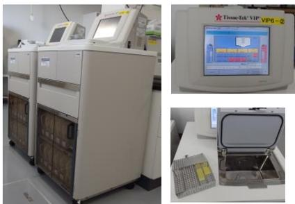
プログラムに従って、固定済みの試料をアルコールによる脱水・脱脂、中間剤のキシレンによる脱アルコールに続き包埋剤\*のパラフィン浸透を自動的に密閉状態で行う。加圧減圧機能、液攪拌機能を備えている。\*包埋剤として融点が58°C前後のパラフィンを使用している。
