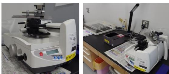
パラフィンブロックを固定台に挟み、刃を滑走させて試料を数 $\mu\text{m}$ に薄切する装置。クローズドローラーベアリング方式のパラフィンブロック用マイクロトーム。枚数カウンターやTOTAL ODOの液晶表示、リトラクション機能やオートリバイス機能等を備えている。
