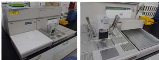
加熱・溶解したパラフィンを包埋皿に満たし、その中にパラフィン置換後の試料を入れ、冷却・固形化してブロックを作製するために使用する。
