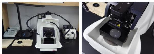
刃を細かく振動させて試料を $20\mu\text{m}$ ～の厚さに切ることができる。固定・脱水・凍結などの操作を加えず切片の作製が可能である。作製した切片は一般的に浮遊切片として染色に用いられる。
