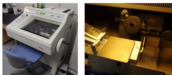
ホルマリンなどにより固定された試料・固定液や有機溶媒の影響を避けて標本作製したい試料を凍結させて薄切することができる。
