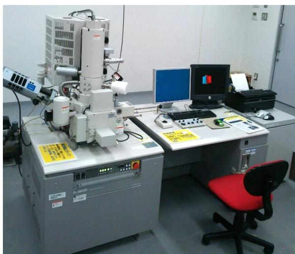
図 5. 使用した走査電子顕微鏡(S-4800 日立ハイテクノロジーズ)
