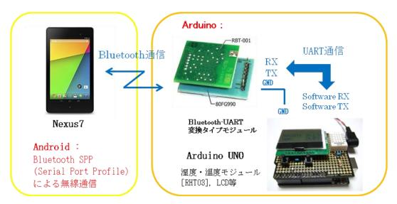
図 2. 機器回路構成
