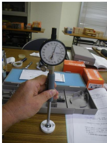
図11. シリンダーゲージの校正
