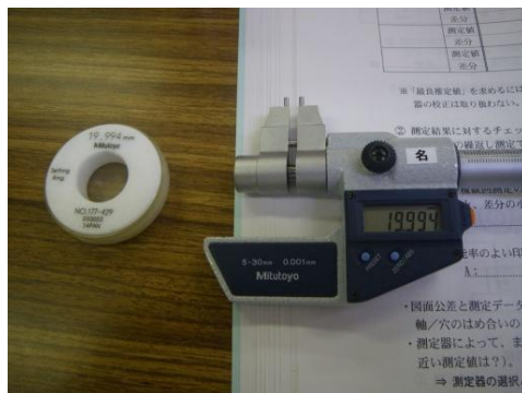
図10. 内測マイクロメータの校正
