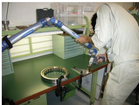
図 1 7 実習の様子 (アングルブロックを測定中)
