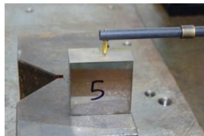
図8 表面粗さ計で測定中の試験片
