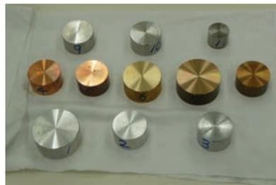
図 1 2 硬さ試験 試験片 (11種)
