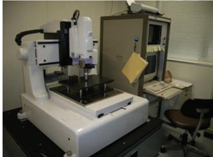
図6 非接触式三次元測定器の外観
