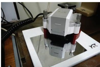
図 1 3 原子間力顕微鏡
