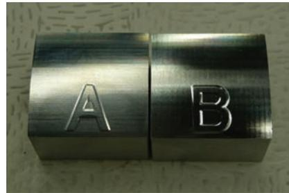
図3 加工した試験片
