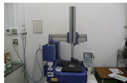
図9 接触式三次元測定器
