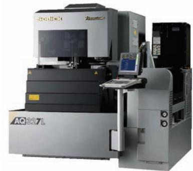
図4 ワイヤカット放電加工機
