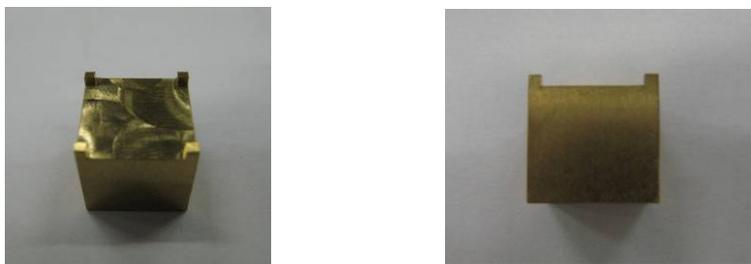
図 6. 溝加工用ワーク(真鍮)
